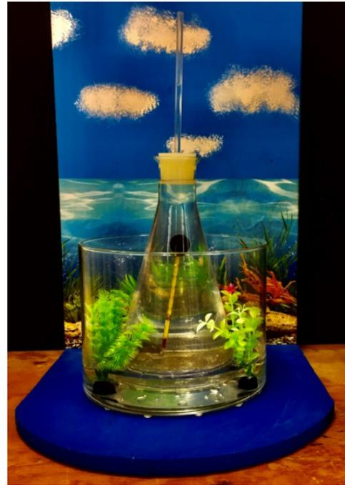
*Abb. 51: Versuch „thermische Ausdehnung von Wasser (eigene Aufnahme)*
