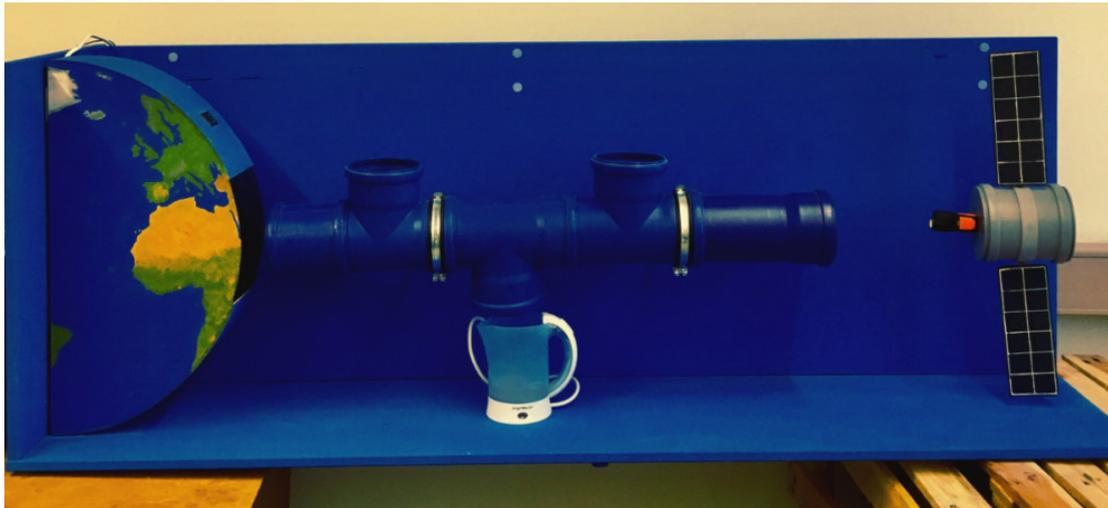
Abb. 38: Versuch zur Messung der Treibhausgaswirkung von Wasserdampf (eigene Darstellung)
