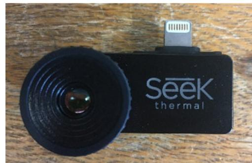
Abb. 28: Wärmebildkamera (eigene Aufnahme)
