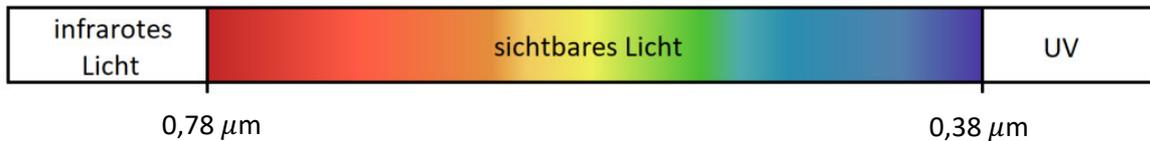
Abb. 6: Spektralbereiche der elektromagnetischen Strahlung (eigene Darstellung)
