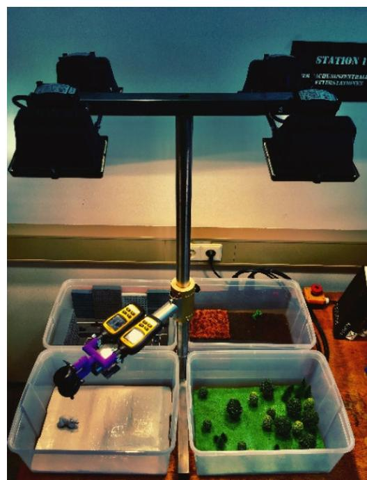
Abb. 27: Versuch „Albedo“ mit Lampenhalterung (eigene Aufnahme)
