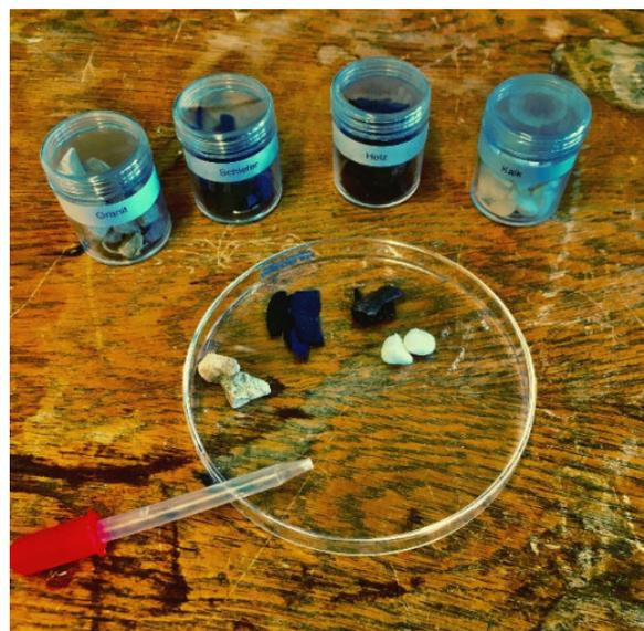
Abb. 58: Untersuchung von Holz, Kalk, Schiefer und Granit auf ein Reaktionsverhalten mit Säure (eigene Aufnahme)
