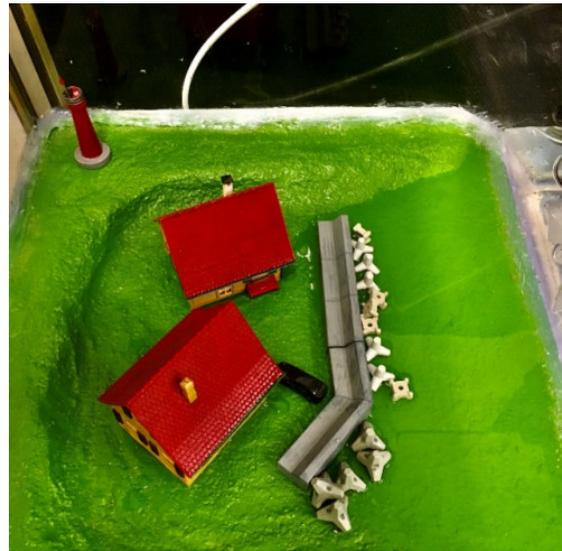
Abb. 52: Modelldorf mit möglichen Küstenschutzmaßnahmen (eigene Aufnahme)
